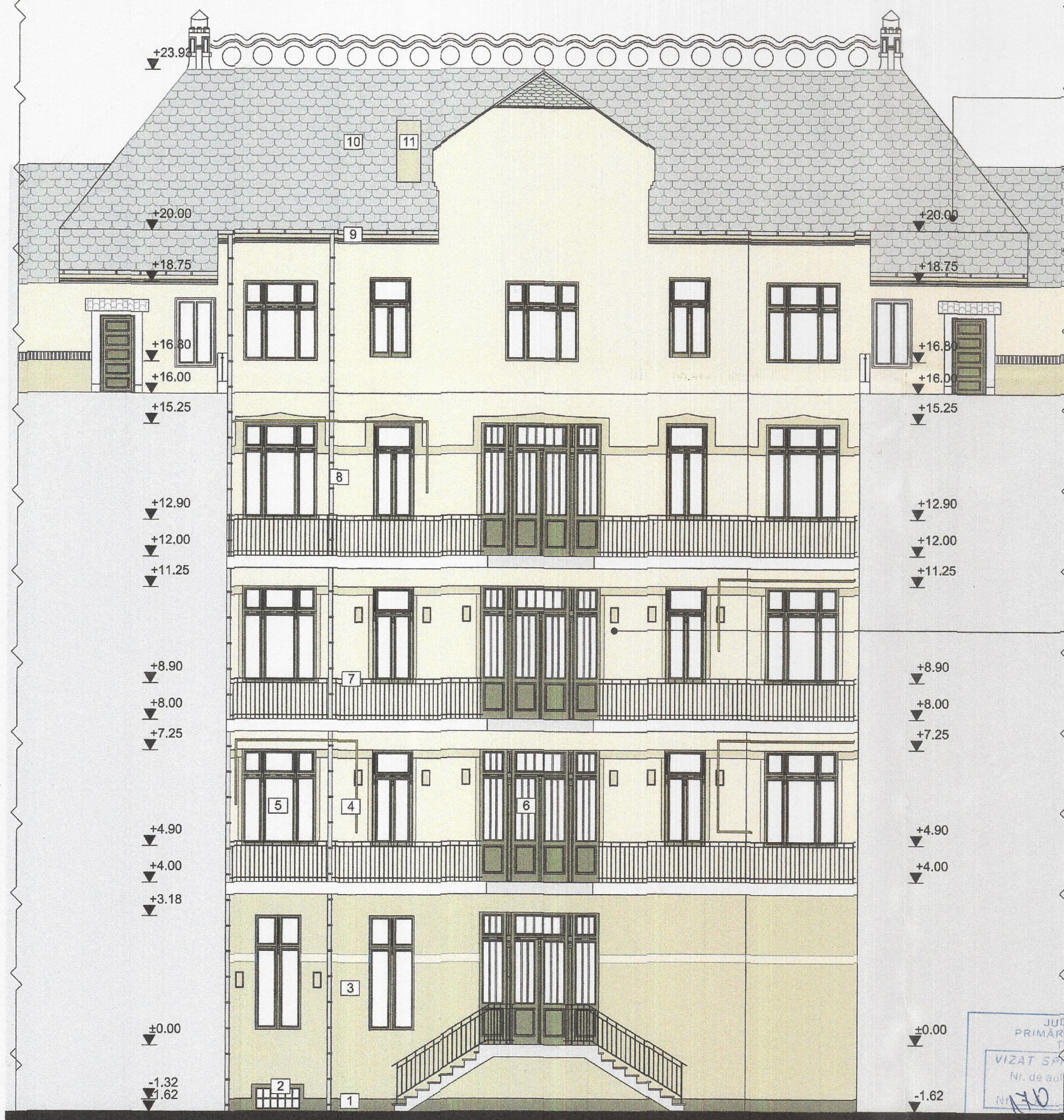
FATADA EST - CURTE INTERIOARA PROPUS SCARA 1:100
